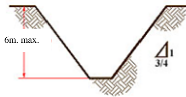
TALUD SIMPLE - GENERAL TIPO DE SUELO A
