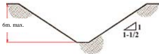
TALUD SIMPLE TIPO DE SUELO C
